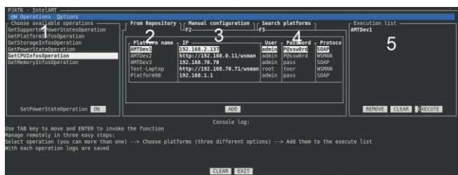
Rys. 9. Początkowe okno interfejsu TUI, gdzie: 1 - wybór operacji, 2 - wyświetlanie wszystkich komputerów z repozytorium, 3 - ręczne skonfigurowanie parametrów komputerów, 4 - wyszukiwarka komputerów w sieci, 5 - lista z wybranymi komputerami. Do korekty listy 5 służą przyciski: „REMOVE”, który usuwa zaznaczoną pozycję i „CLEAR”, który czyści listę. Przycisk „EXECUTE” wykonuje wskazane operacje na wybranych komputerach, na bieżąco informując użytkownika o postępie prac w konsoli okna.
