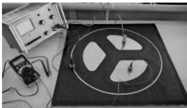
Rys. 4. Układ do badania rozkładu natężenia pola elektrycznego na modelu analogowym kabla sektorowego.
