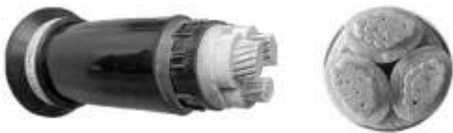
Rys. 2. Kabel elektroenergetyczny YAKY z żyłami aluminiowymi, o izolacji polwinitowej, z żyłą powrotną miedzianą nałożoną na powłokę, o powłoce polwinitowej ( U_n = 3,6/6 kV)
